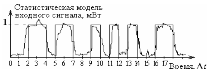
Рис. 4.4. Статистическая модель цифрового сигнала с учетом шума, джиттера и ДВИ в канале передачи E1. Ровными линиями представлен идеальный сигнал в коде СМ1 (с инверсией комбинаций) [20]
